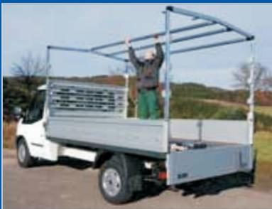
Einbau der Spiegelrohre
